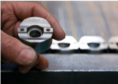
1. Vorbearbeitete Rohlinge werden nach dem Härten zum Profilschleifen auf den Magneten aufgelegt.
