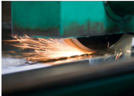
3. Vollautomatischer Schleifprozess für Profilschleifen
