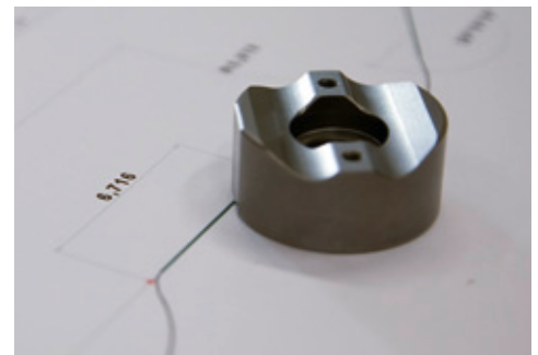
6. Fertiges Teil mit Messprotokoll
